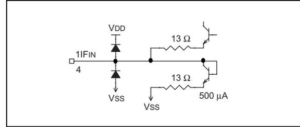
**FIGURE 2-5: BLOCK DIAGRAM OF MIXER1 BIAS PINS**
