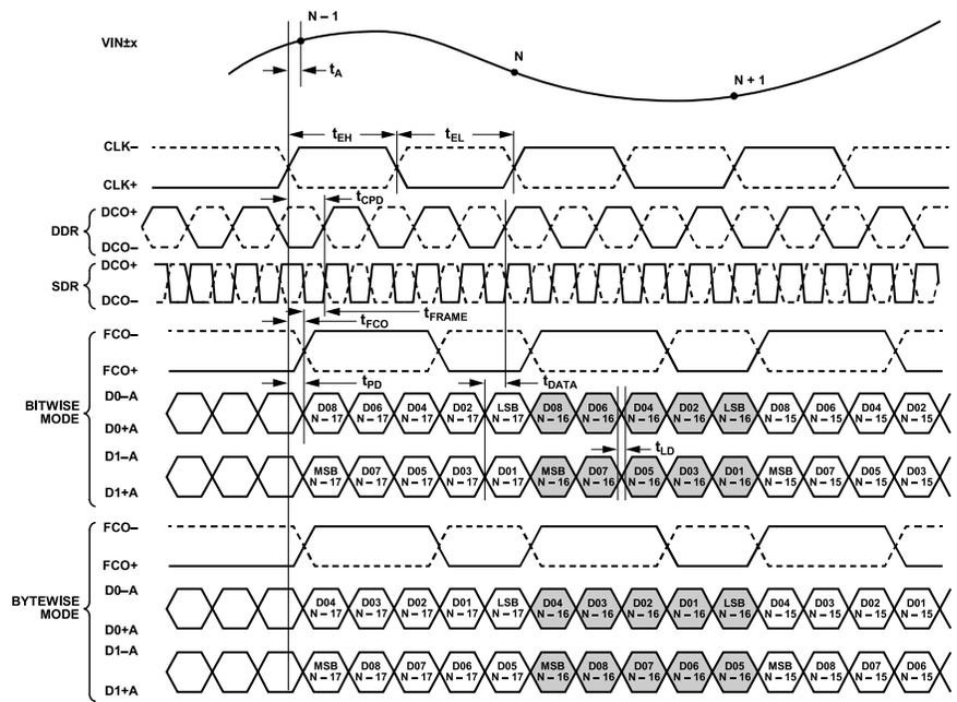
Figure 3. 10-Bit DDR/SDR, Two-Lane, 1x Frame Mode
