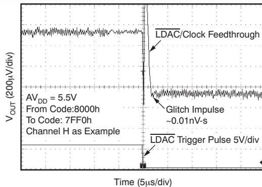
Figure 65. Glitch Energy: 5 V, 16-LSB Step, Falling Edge
